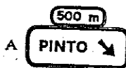
S-230 PRESEÑALIZACION CON SEÑALES SOBRE LA CALZADA EN CARRETERA CONVENCIONAL HACIA CARRETERA CONVENCIONAL
