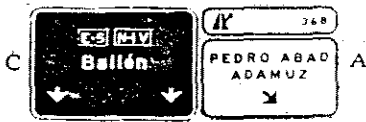
S-366 SEÑALES SOBRE LA CALZADA EN AUTOPISTA O AUTOVIA. SALIDA INMEDIATA HACIA CARRETERA CONVENCIONAL Y DIRECCION PROPIA
