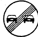
R-502 FIN DE LA PROHIBICION DE ADELANTAMIENTO
