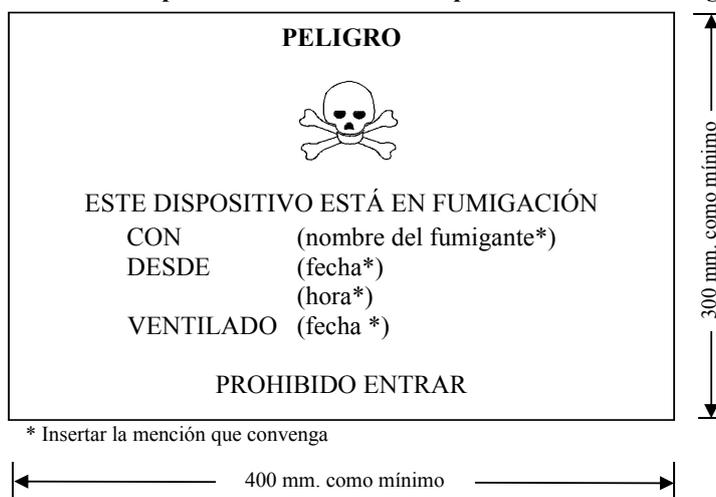
La marca deberá tener una forma rectangular y medir al menos 400 mm de largo y 300 mm de alto. El espesor mínimo de la línea exterior debe ser de 2 mm. La marca debe ser negra sobre fondo blanco y las letras deben medir al menos 25 mm de altura. Cuando no se especifiquen las dimensiones todos los elementos deben respetar aproximadamente las proporciones representadas anteriormente.
