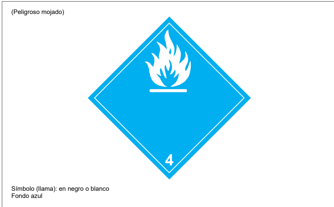
Figura 5-15. Sustancia que en contacto con el agua emite gas inflamable, Clase 4, División 4.3
