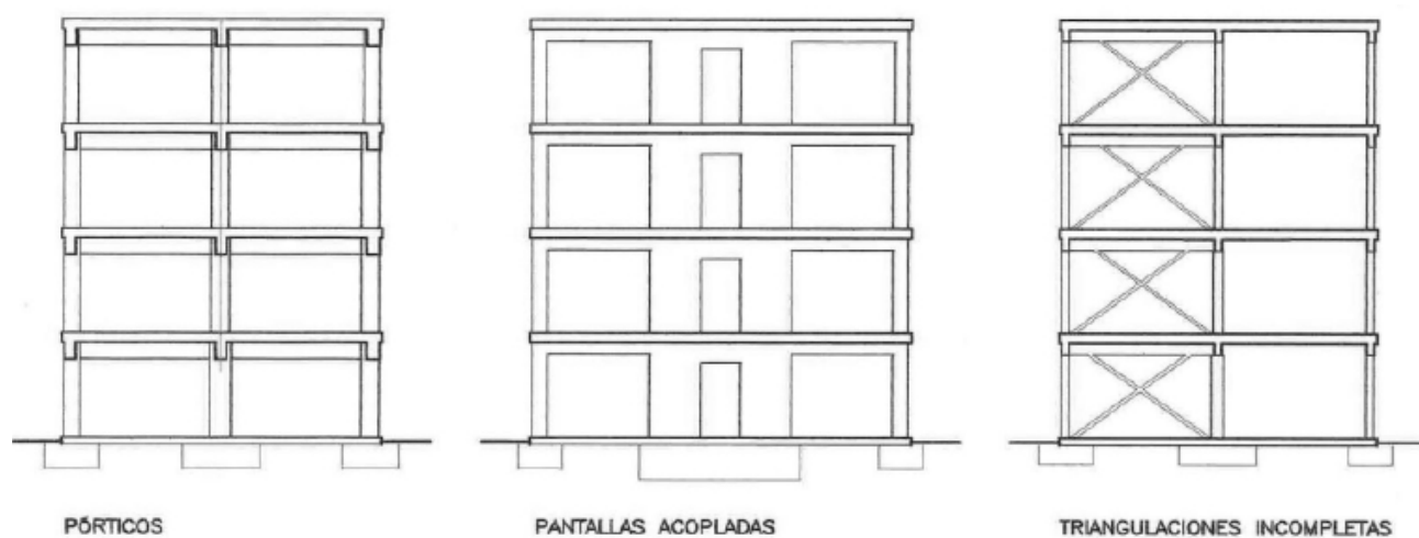
Figura 3.4.- Exemplos de organizacións estruturais que permiten un valor do coeficiente de comportamento por ductilidade \mu = 4 .
