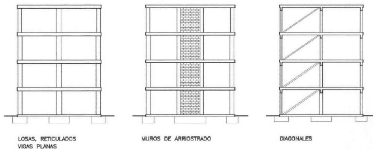
Figura 3.5.- Exemplos de organizacións estruturais que permiten un valor do coeficiente de comportamento por ductilidade \mu = 3 .
