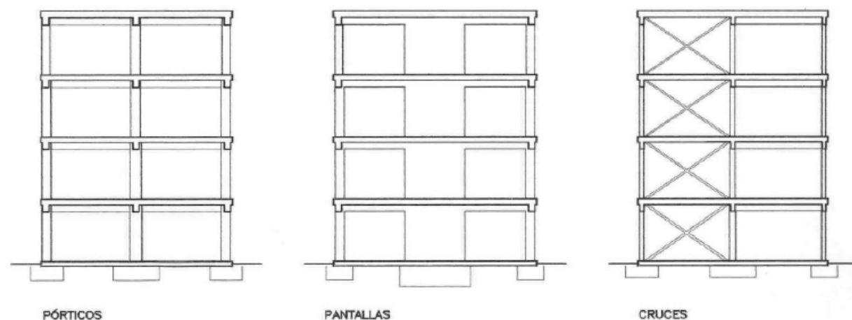
Figura 3.5.- Exemplos de organizacións estruturais que permiten un valor do coeficiente de comportamento por ductilidade \mu = 3 .
