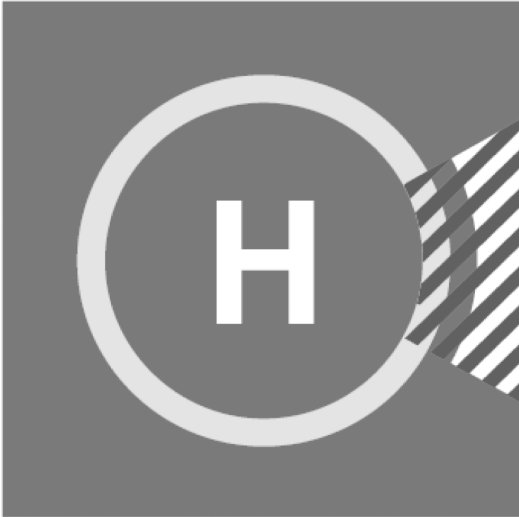
Figura 5-5 Señal de sector de aterrizaje prohibido en la heliplataforma
