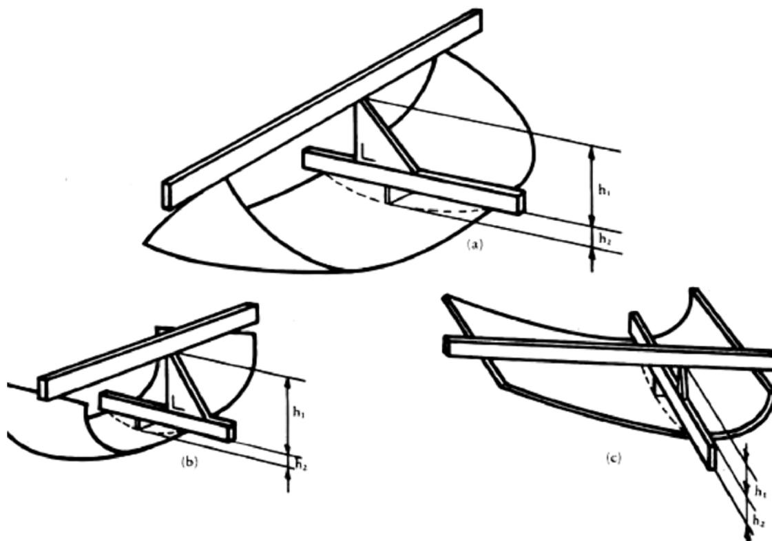
Figura 1 — Determinación de la altura de segmento «h»
