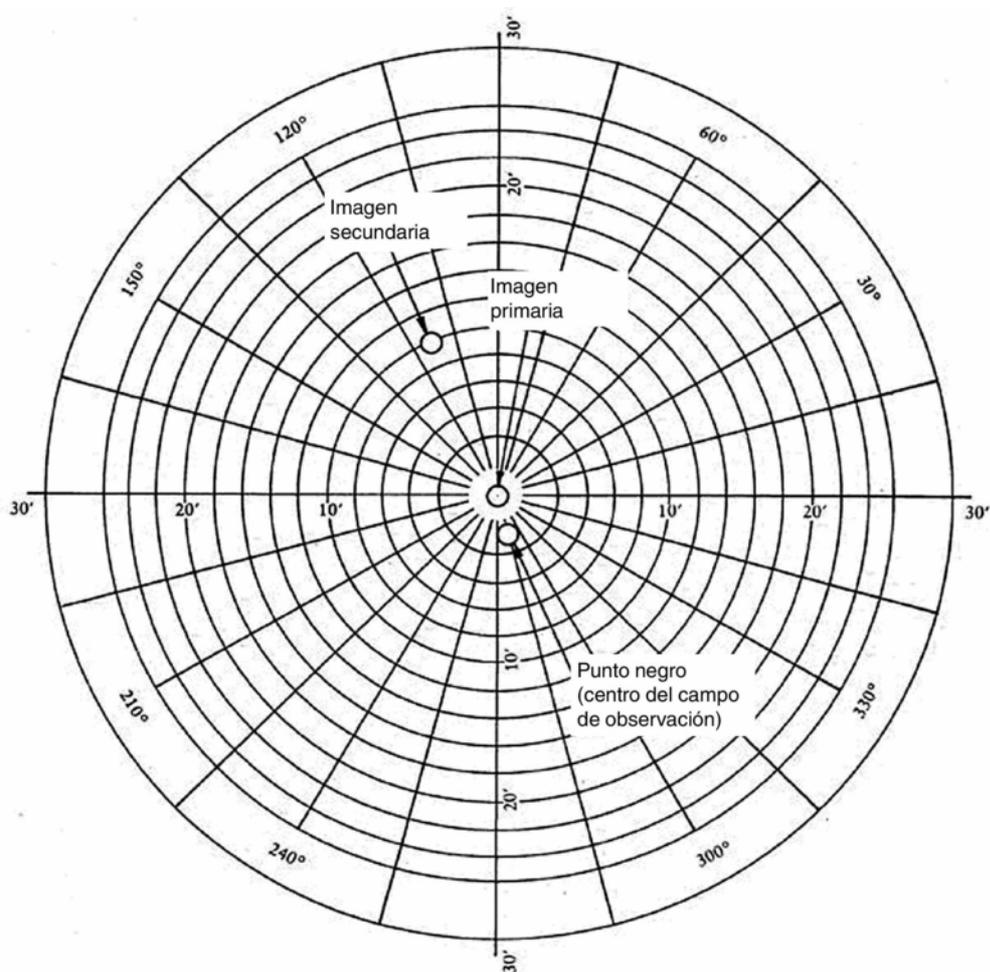
**Figura 14 - Ejemplo de observación por el método de ensayo con colimador**
