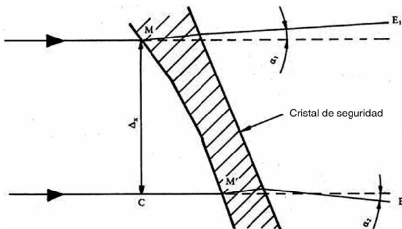
Figura 6 - Representación esquemática de la distorsión
