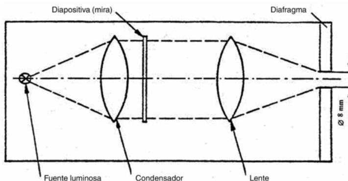
Figura 7 - Disposición óptica del proyector
