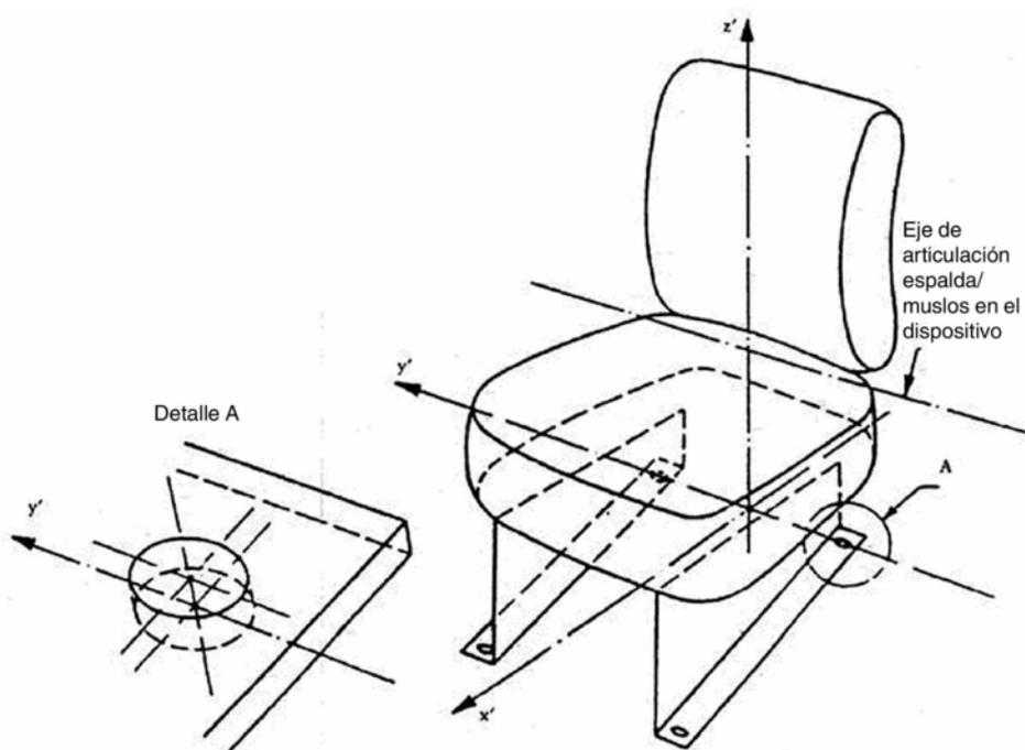
Figura 12 — Determinación de los tres ejes de referencia del SIP
