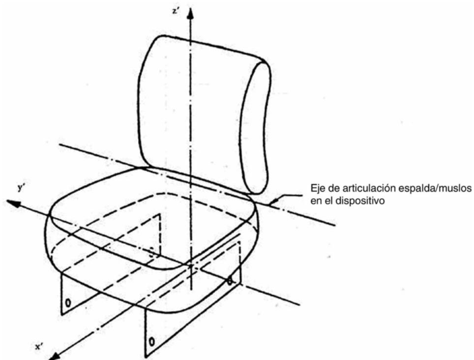
Figura 11 — Determinación de los ejes de referencia del SIP
