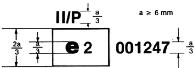
La marca de homologación del presente gráfico, fijada sobre un parabrisas de vidrio laminado ordinario recubierto de materia plástica, indica que dicho elemento ha sido homologado en Francia (e 2), con arreglo a la presente Directiva, con el número de homologación 001247.
