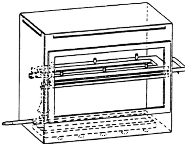
Figura 15 - Ejemplo de cámara de combustión con portamuestras y cubeta
