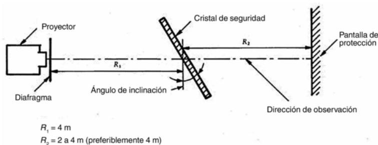
Figura 9 - Disposición del equipo para el ensayo de distorsión óptica
