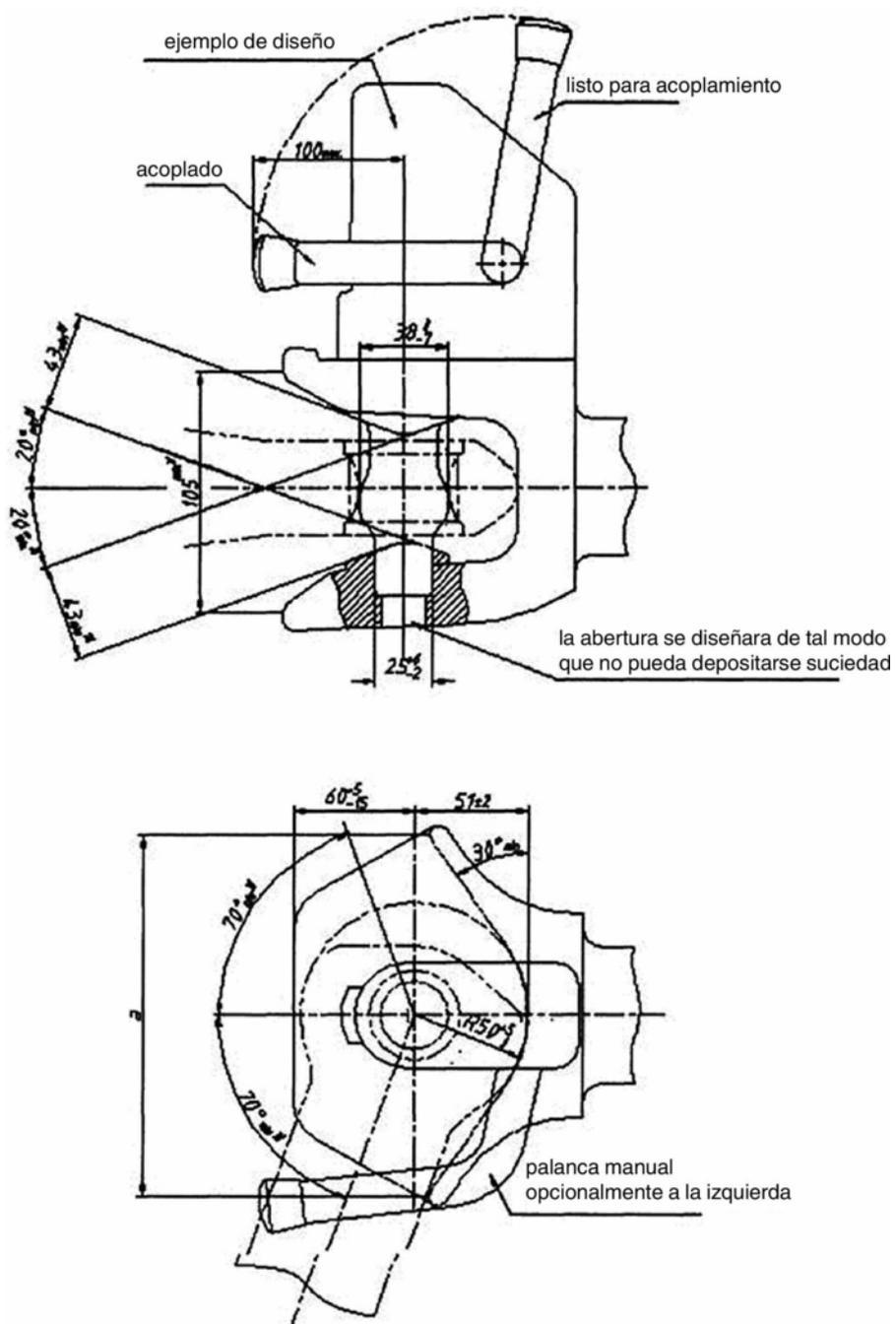
Figura 1.c — Dispositivo de enganche automático, con perno muescado
