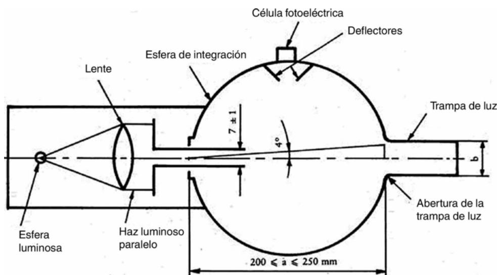
Figura 5 - Equipo para la medición de la atenuación de visibilidad
