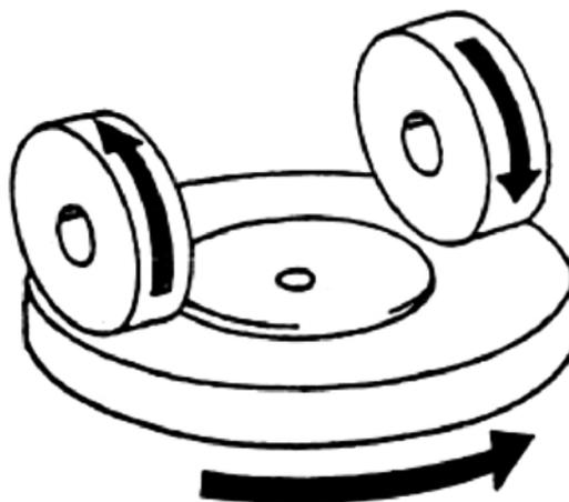
**Figura 4 - Esquema del dispositivo de abrasión**
