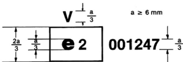
La marca de homologación del presente gráfico, fijada sobre un cristal que no sea parabrisas al que se aplican las disposiciones del punto 9.1.4.2 del Anexo III C, indica que dicho elemento ha sido homologado en Francia (e 2), con arreglo a la presente Directiva, con el número de homologación 001247.
