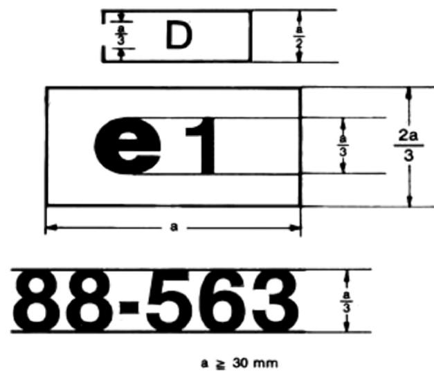
El enganche provisto de la marca de homologación CE que aparece más arriba obtuvo una homologación CE, con el número 88-563, en la República Federal de Alemania (e 1), habiendo sido sometido al ensayo dinámico de resistencia (D).
