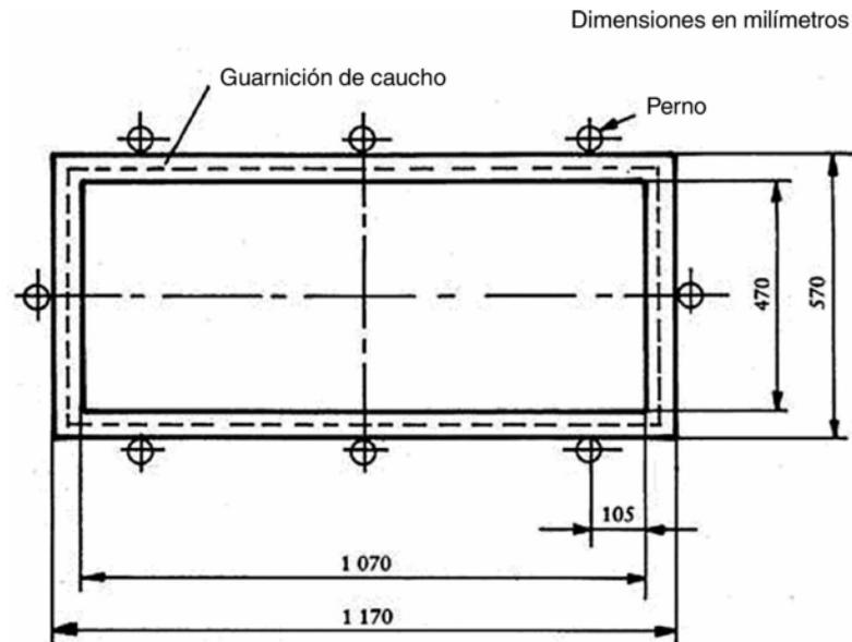
Figura 3 - Soporte para los ensayos con cabeza simulada
