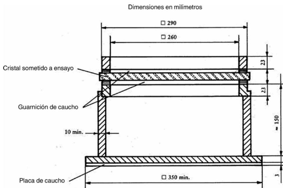
Figura 1 - Soporte para los ensayos de bola
