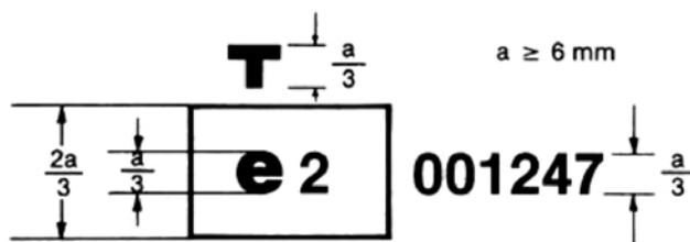
La marca de homologación del presente gráfico fijada sobre un cristal indica que dicho elemento, destinado a ser utilizado como parabrisas en un tractor, ha sido homologado en Francia (e 2), con arreglo a la presente Directiva, con el número de homologación 001247.
