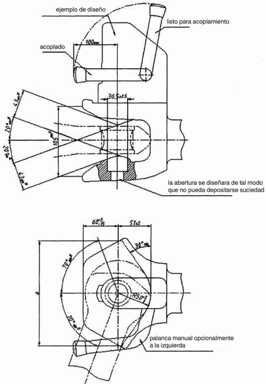
Figura 1.b — Dispositivo de enganche automático, con perno cilíndrico
