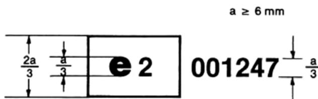
La marca de homologación del presente gráfico, fijado sobre un cristal que no sea parabrisas al que se aplican las disposiciones del punto 9.1.4.1 del Anexo III C, indica que dicho elemento ha sido homologado en Francia (e 2), con arreglo a la presente Directiva, con el número de homologación 001247.
