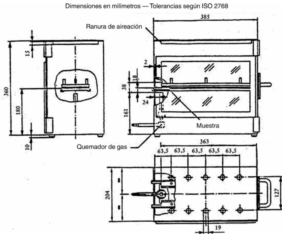
Figura 16 - Ejemplo de cámara de combustión
