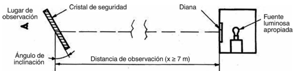
Figura 12 - Disposición del equipo
