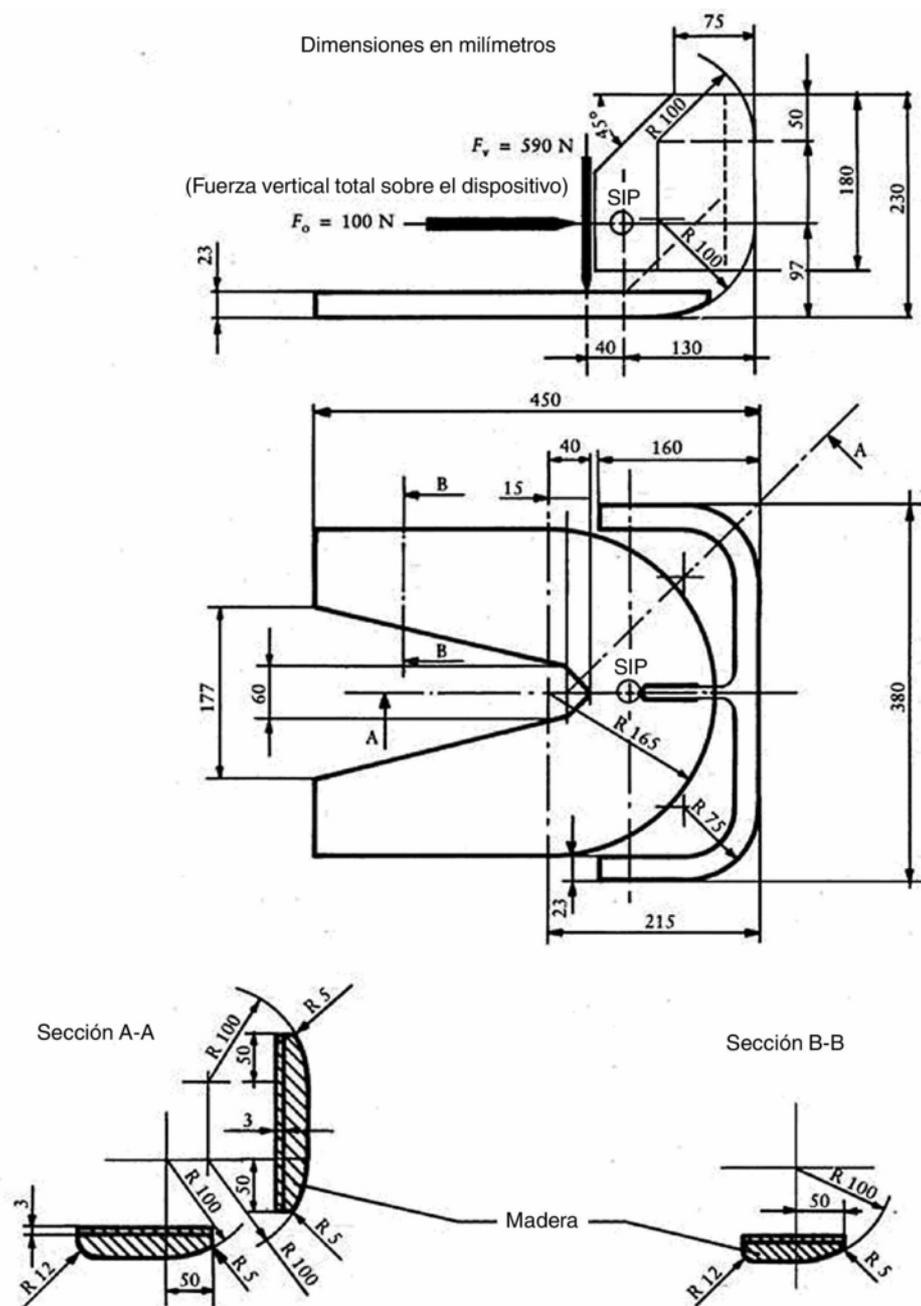
Figura 10 — Dispositivo para determinar el punto de referencia del asiento (SIP)
