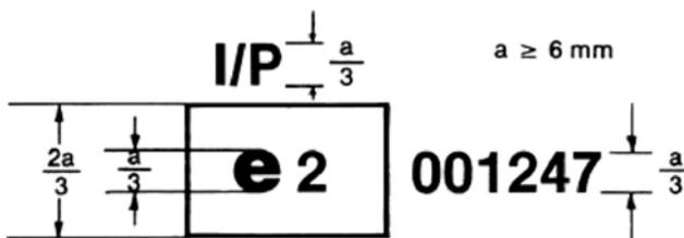
La marca de homologación del presente gráfico, fijada sobre un parabrisas de vidrio templado recubierto de materia plástica, indica que dicho elemento ha sido homologado en Francia (e 2), con arreglo a la presente Directiva, con el número de homologación 001247.
