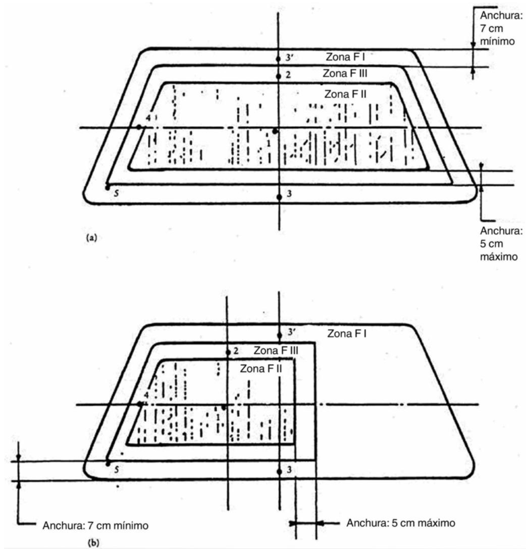
Figura 2 — Puntos de impacto previstos para los parabrisas
